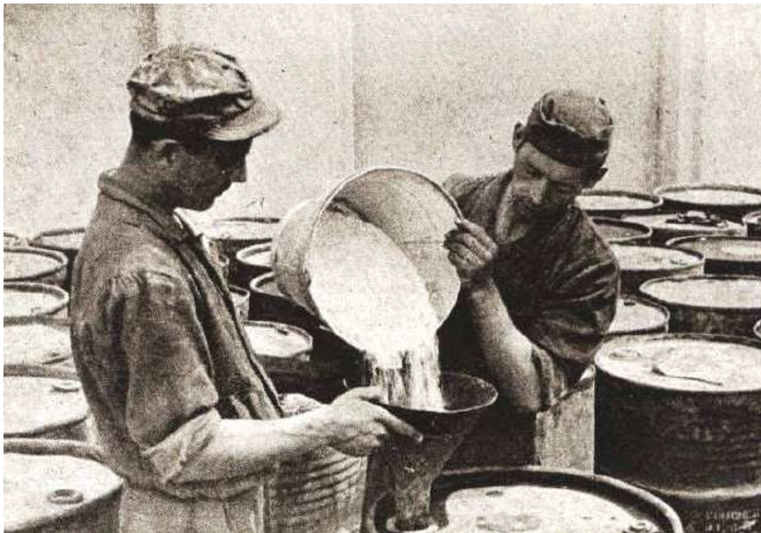
Il DDT pesato, viene versato nei fusti contenenti 150 kg. di petrolio
